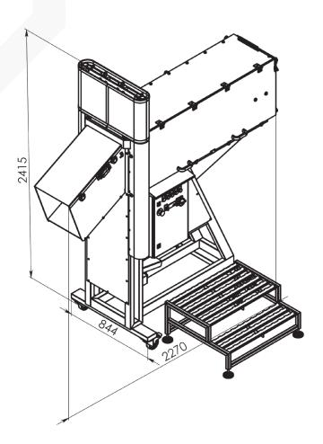
La machine de découpe des blocs de beurre SLP est conçue pour couper des blocs de beurre de 10 à 25 kg en petits morceaux avant l'homogénéisation, le reconditionnement ou autres processus.
