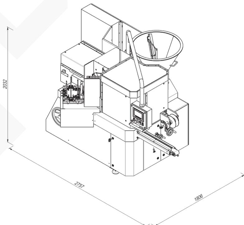
Machine de conditionnement automatique AR6U pour envelopper d'une feuille d'aluminium le fromage fondu et le conditionner dans un carton individuel.
